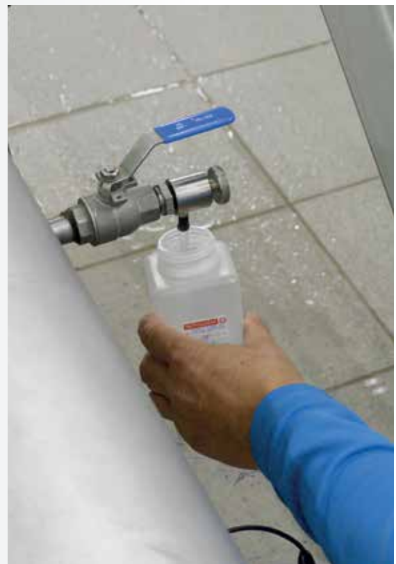
In regelmäßigen Abständen werden Proben von der Hofinger Quelle, dem Tiefbrunnen Fürhölzl, allen Speicherbehältern und aus dem Versorgungsnetz entnommen.
